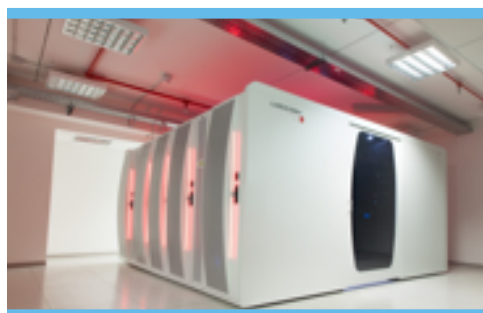
Figura 13. La piattaforma APOTECA per la gestione robotizzata della produzione i.v. in farmacia
