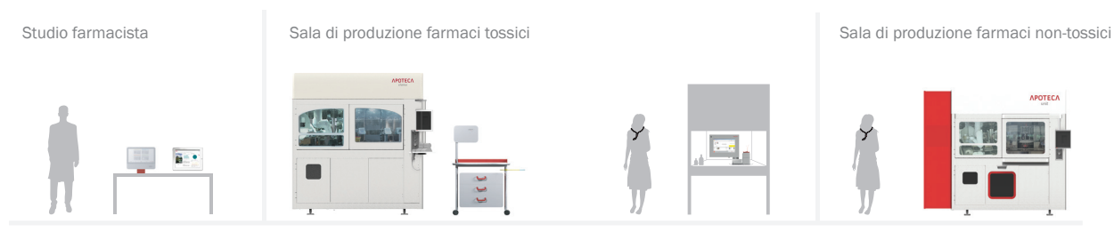
Figura 13. La piattaforma APOTECA per la gestione robotizzata della produzione i.v. in farmacia
